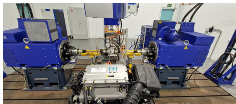
Ilustración 5. Pila de combustible montada en el banco e-Axle
